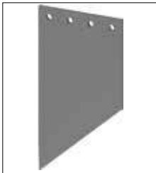
334.034.4: X形刀（斜）。 附件 UPG 10。 用于没有螺旋的软管组件，具有从薄到厚的壁厚。 在切割过程中防止软管变形 = 非常直的切割。
