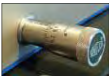
千分尺设置扣压尺寸 (Control A)
