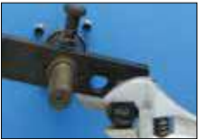
对于 USM 10 S 上的每个软管尺寸，只需对剥胶深度进行一次刀片调整。
