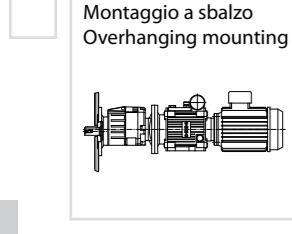
Per il montaggio a sbalzo, verificare il peso del gruppo e l'entità delle possibili oscillazioni. In caso di dubbi, contattare Var-Spe.
