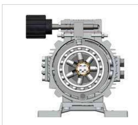
Il variatore è dotato di due valvole di sicurezza, tarabili, che interrompono il moto tra variatore e macchina condotta nei casi in cui si manifesti una coppia superiore a quella tarata, allo scopo di evitare eventuali danni per arresti accidentali della macchina.
